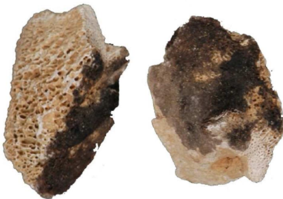
Rysunek 5: Aglomeraty żużlu pochodzące ze spalania odpadów komunalnych
