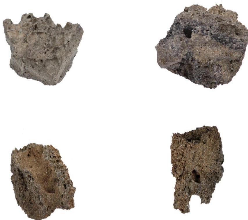
Rysunek 1: Aglomeraty żużlu pochodzące z kotła z rusztem schodkowym spalarni odpadów Targówek w Warszawie
