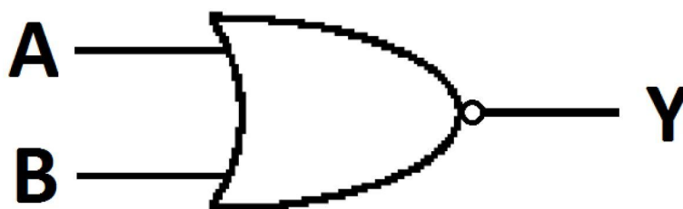
Rys. 4 Symbol graficzny bramki logicznej NOR
