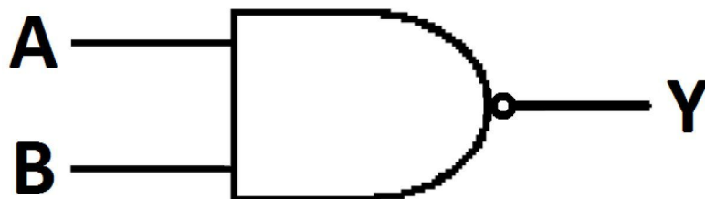
Rys. 2 Symbol graficzny bramki logicznej NAND
