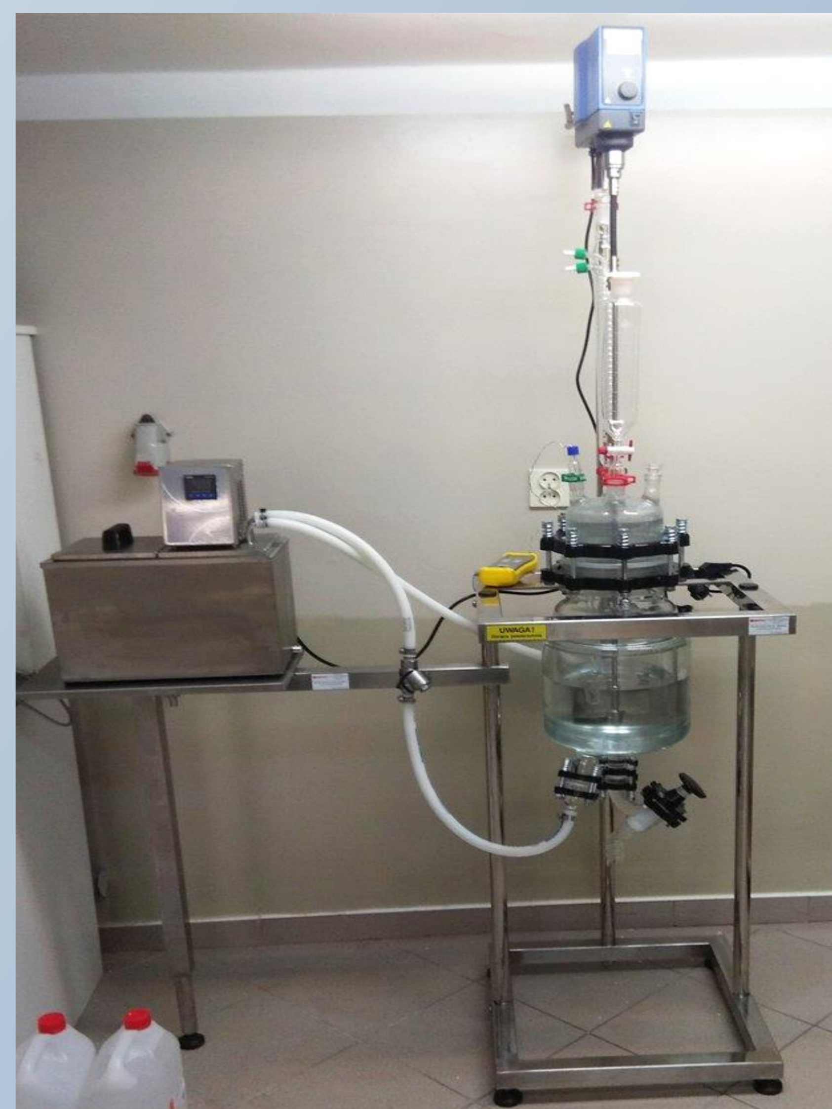
Rys. 3. Instalacja pilotażowa do recyklingu odpadowego poli (kwasu mlekowego) [PLA]
