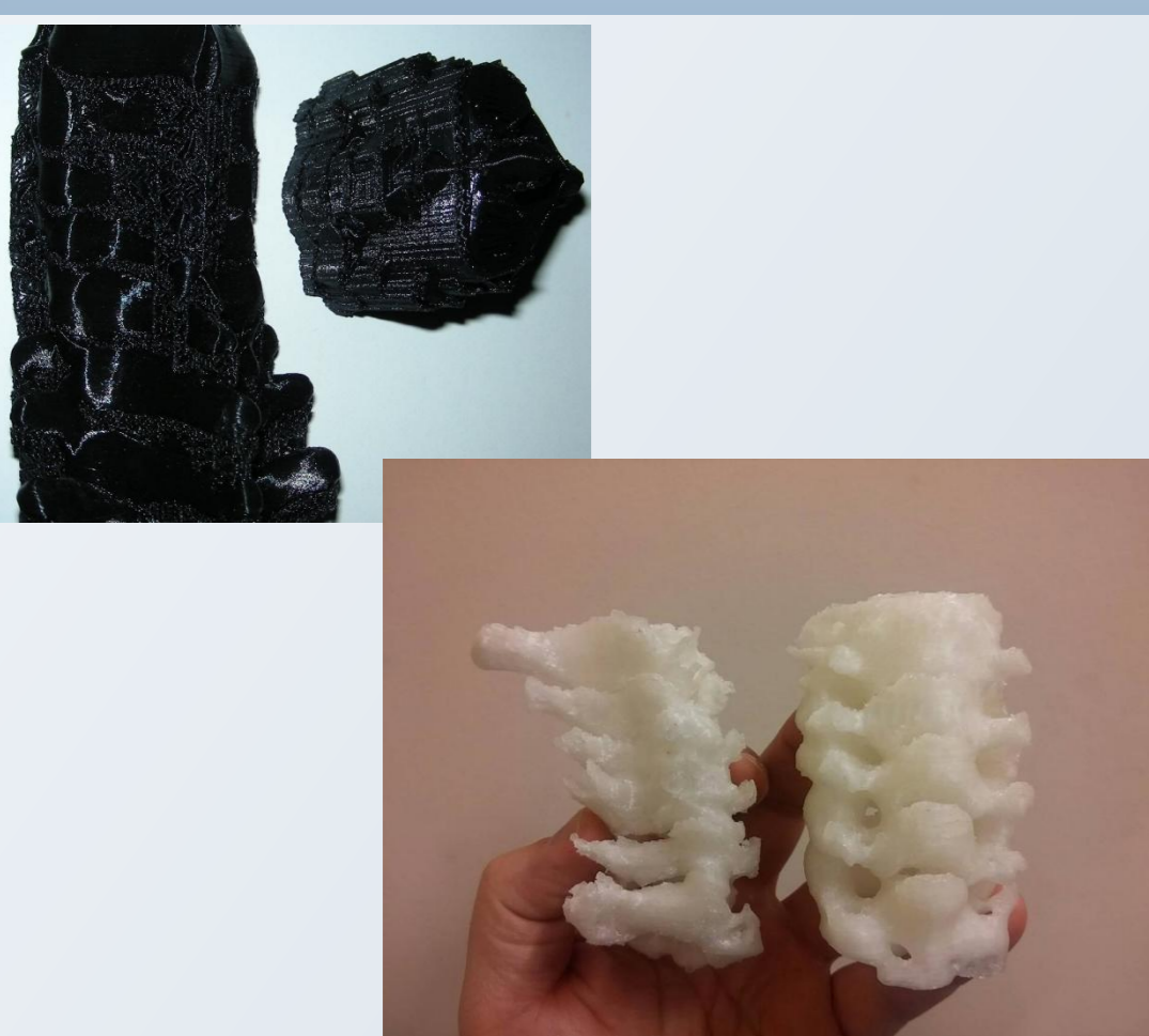
Rys. 5. Replika górnego odcinka kręgosłupa. Czarny model posiada nieusuniętą podporę. Biały model jest pomocą pre-operacyjną.
