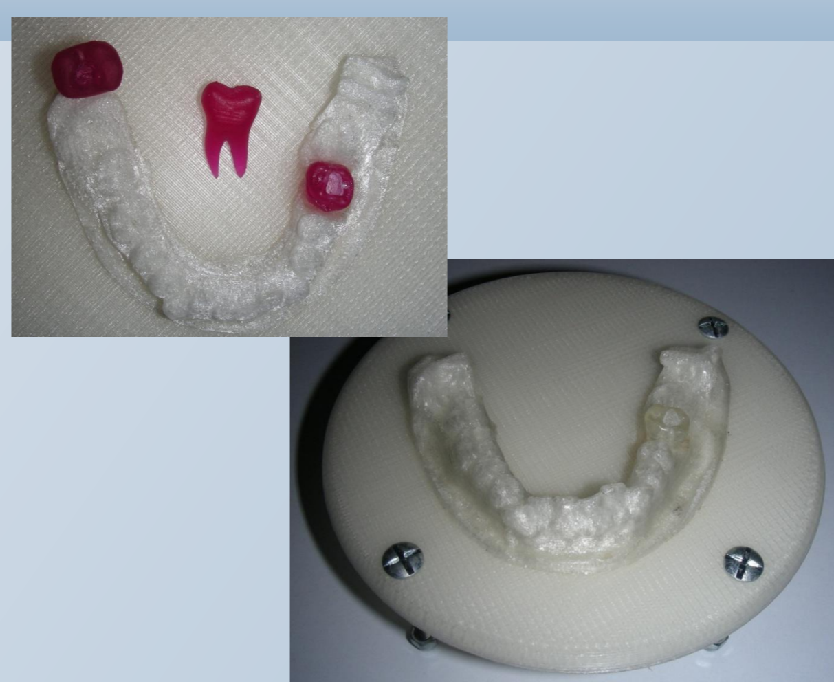
Rys. 7. Dolna szczęka w formie podstawki przeznaczonej do przytrzymywania prototypowych zębów szkoleniowych.
