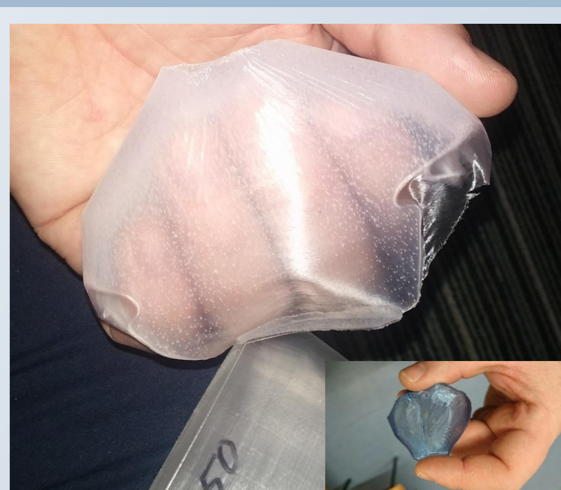
Rys. 6. Replika tkanek miękkich odzwierciedlająca pęcherz oraz niebieska transparentna forma do tworzenia replik prostaty.
