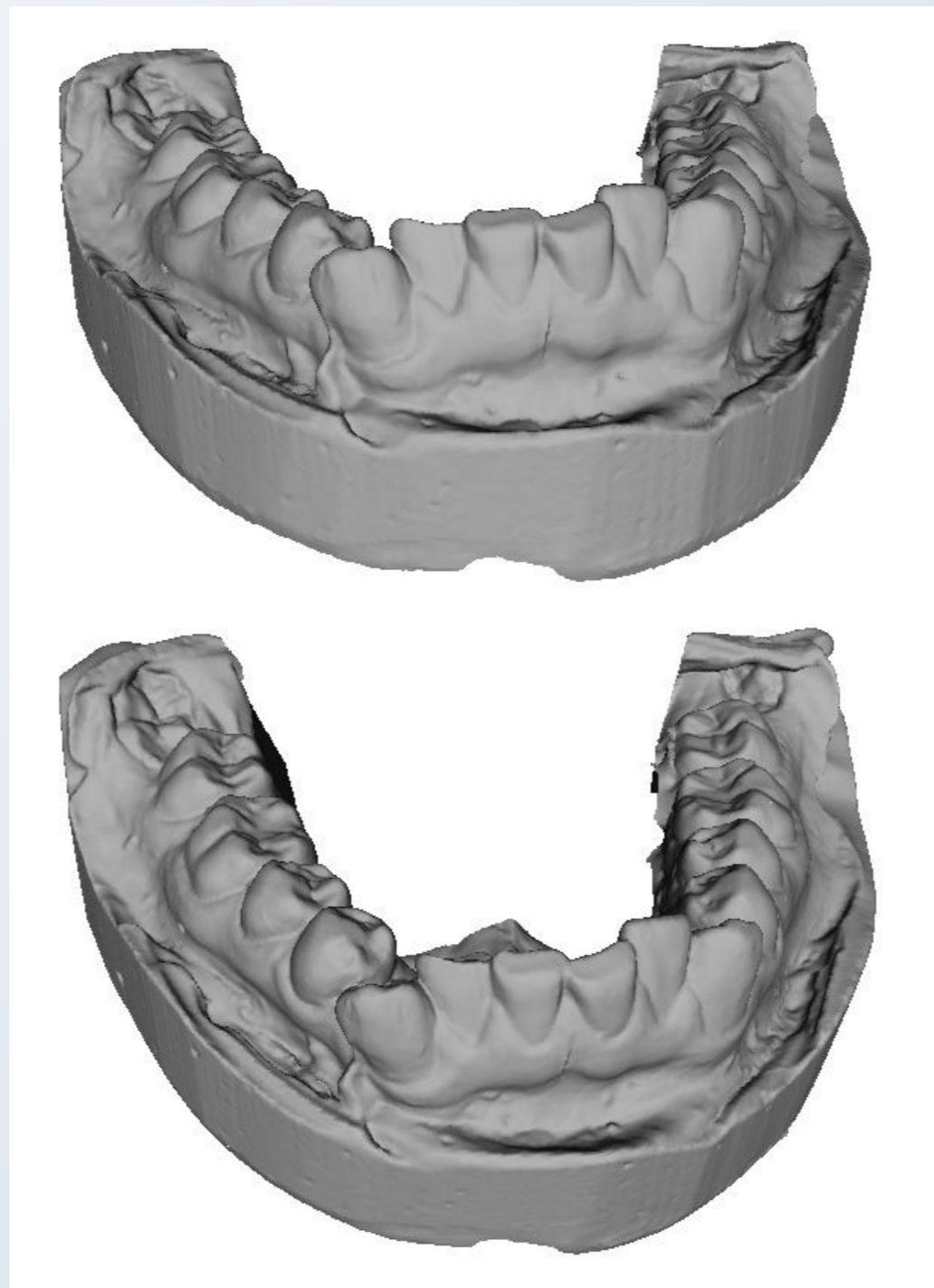
Rys. 3. Geometria 3D uzyskana poprzez obróbkę danych w oparciu o skan linią laserową. Skan wykonany w wysokiej rozdzielczości.
