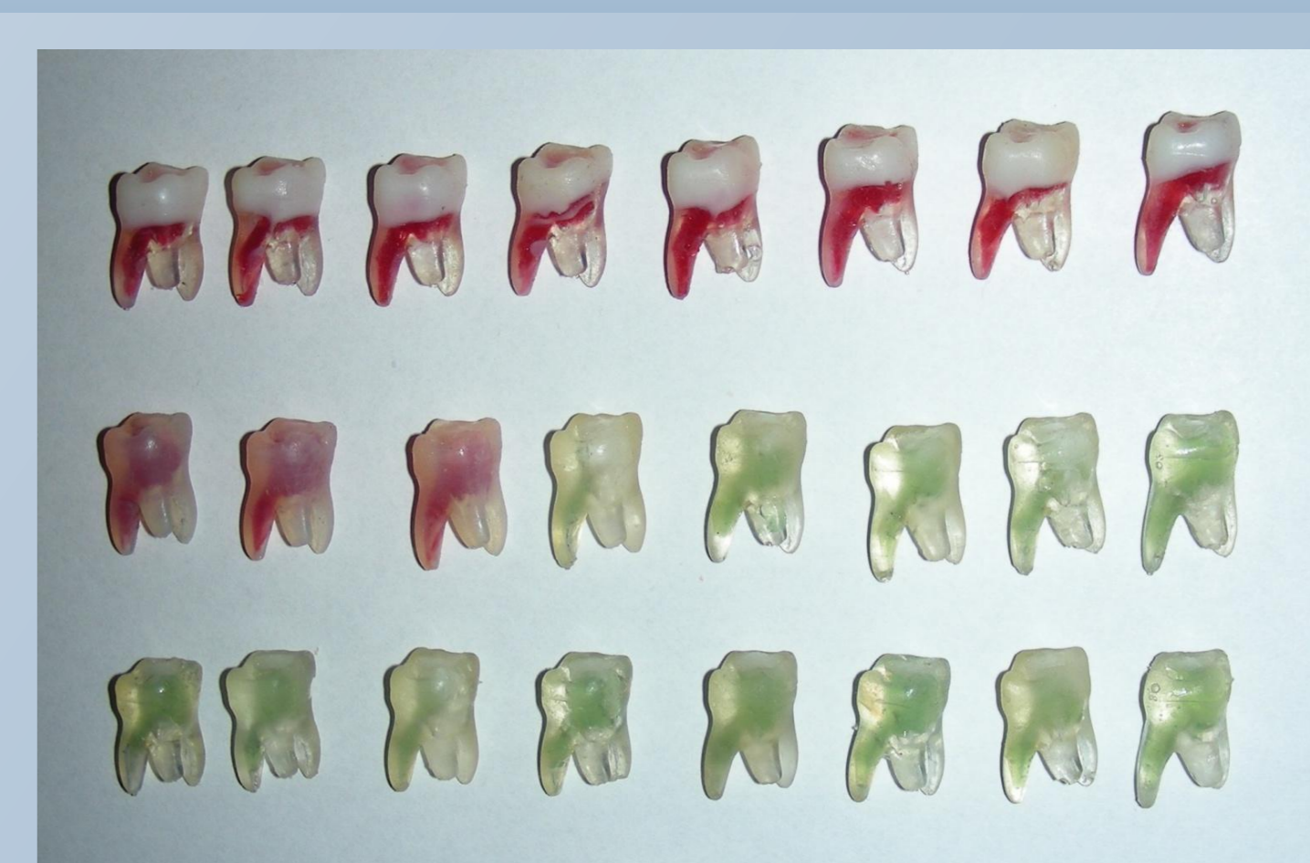
Rys. 8. Cztery typy prototypowych zębów, które posiadają różne właściwości i są zrealizowane w różnych konfiguracjach materiałowych.
