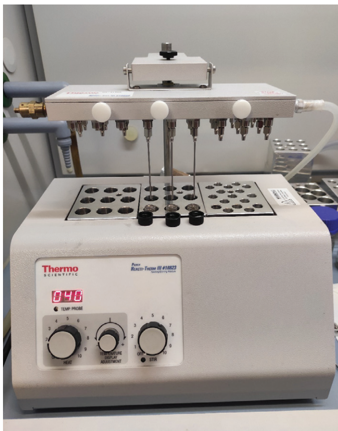
Zdjęcie 17. Odparowanie eluatu w strumieniu azotu
