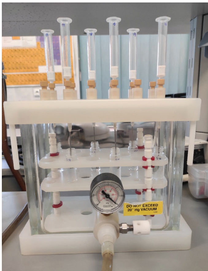
Zdjęcie 16. Oczyszczanie ekstraktu na kolumnkach powinowactwa immunologicznego
