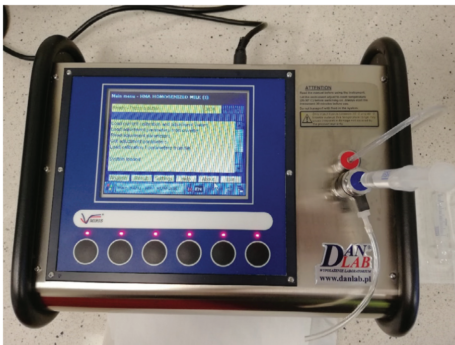
Zdjęcie 20. Analizator składu mleka kobiecego
