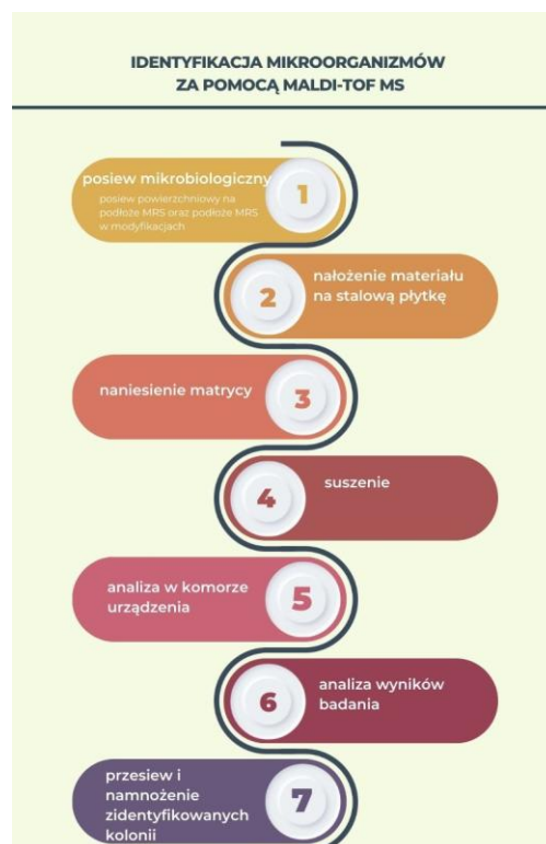
Rysunek 5. Schemat dotyczący procedury identyfikacji bakterii za pomocą MALDI-TOF/MS
